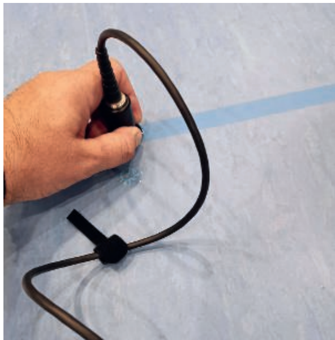
OBEN: Der Sachverständige nutzte das Ultraschallverfahren zur Messung der Beschichtungsstärke.
