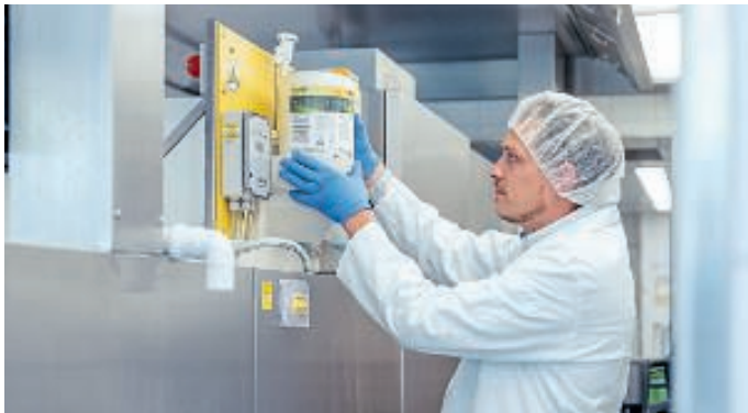
Der Pulverreiniger wird leitwertgesteuert in den Reinigertank der Spülmaschine dosiert.
